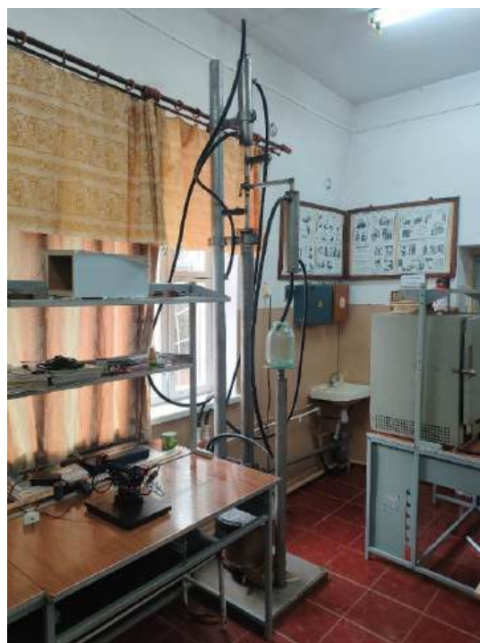
Рис. 2. Ректификационная колонна. Экспериментальная установка
