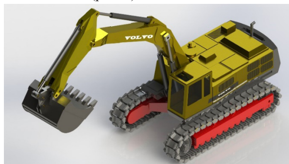
Рис. 1. Компьютерная модель экскаватора EC650, спроектированного в среде SolidWorks
