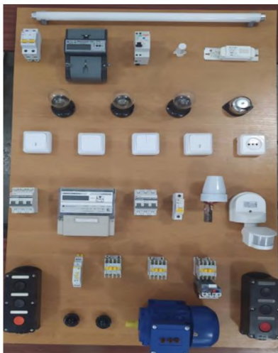
Рисунок 1. Основные коммутационные и защитные аппараты до 1000 В, предназначенных для выполнения лабораторных работ.
